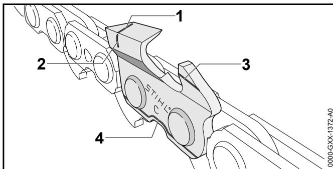
La chaîne STIHL est fabriquée avec des repères d'usure pour aider l'opérateur à identifier une usure excessive. Les repères d'usure décrits ci-dessus (1 - 4) doivent rester visibles.
