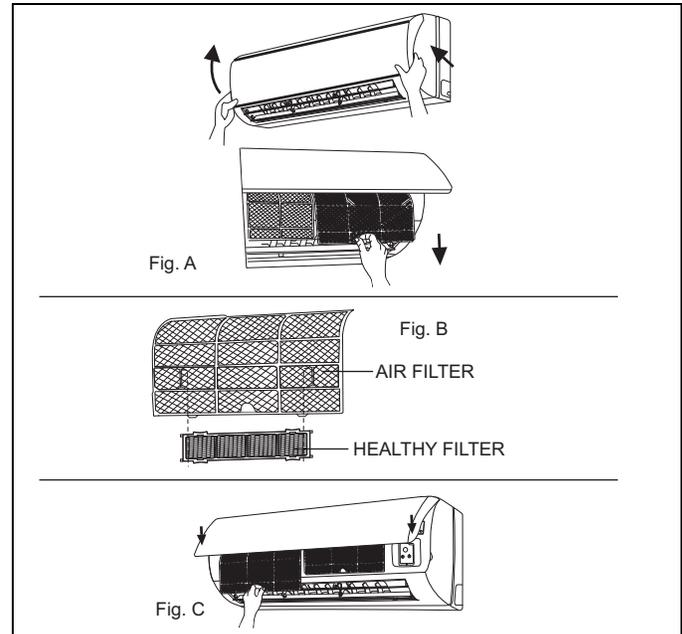
**FIGURE 3:** Filter Replacement
