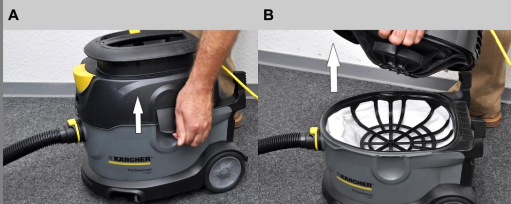
A Desbloquear y extraer el cabezal de aspiración.
