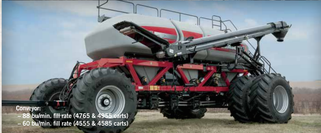
Standard auger – 29 bu/min. fill rate Deluxe auger – 44 bu/min. fill rate
