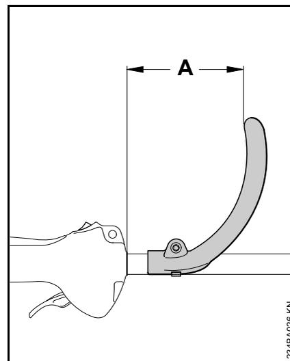
En modifiant la distance (A), on peut amener la poignée dans la position la plus commode suivant l'utilisateur et l'utilisation prévue.
