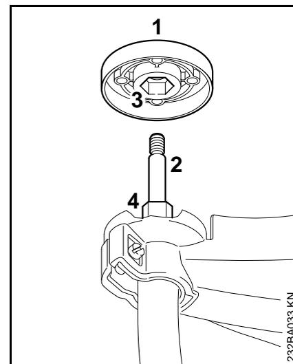
Le disque de pression (1) fait partie du jeu de pièces des têtes faucheuses DuroCut 5-2 und PolyCut 6-3. Il est nécessaire seulement si l'on utilise ces têtes faucheuses.
